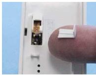
2.1. зафиксировать распределитель на тепловом адаптере, нажать на нижнюю часть и защелкнуть пломбу, входящую в комплект поставки.
